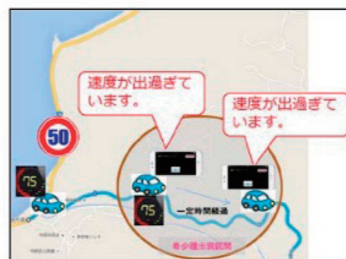
②動物事故多発地域における速度超過時における音声アラート
